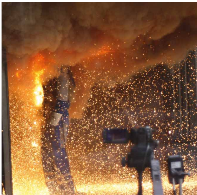
Beispiel: Auswirkungen eines Kurzschlusslichtbogens
