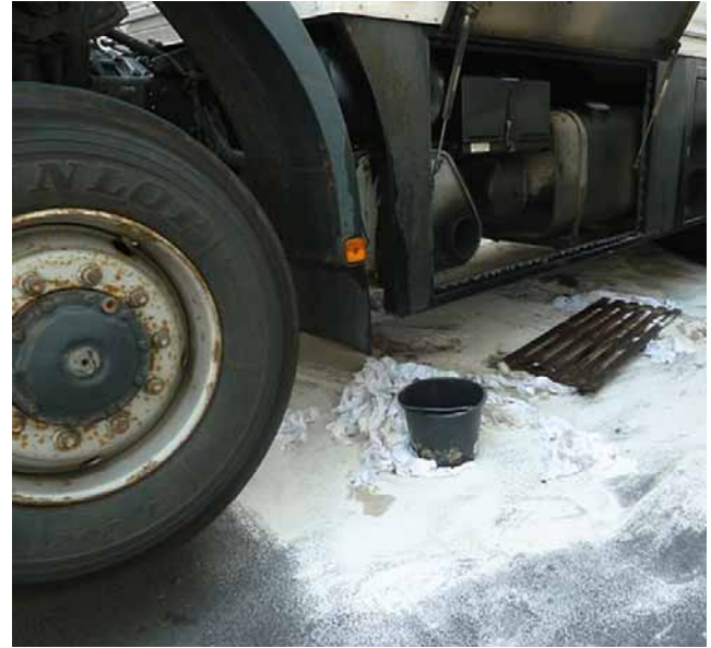
Beispiel: Schadensfall mit Ölaustritt und Einsatz von Ölbindemittel
